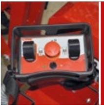
**FERNVERBINDUNG MIT KABEL FÜR FAHREN**
